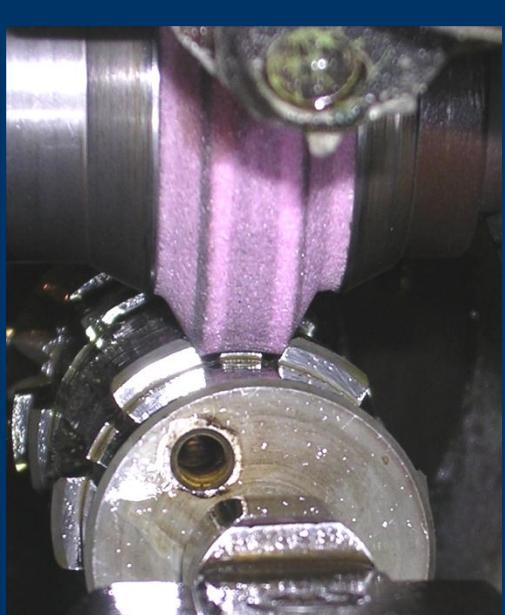
**brušenje složenih površina (brušenje žljebova)**
