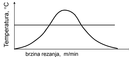
a) Solomon-ova krivulja ovisnosti temperature o brzini rezanja
