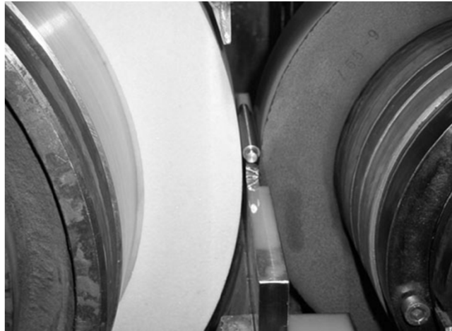
Vanjsko obodno okruglo brušenje bez šiljaka
