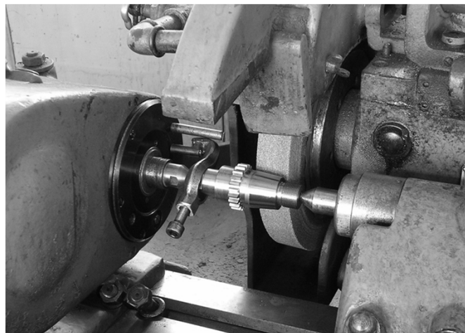
Vanjsko obodno okruglo brušenje konusa
