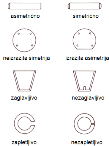
Slika 73. Geometrijska obilježja koja utječu na rukovanje dijelovima
