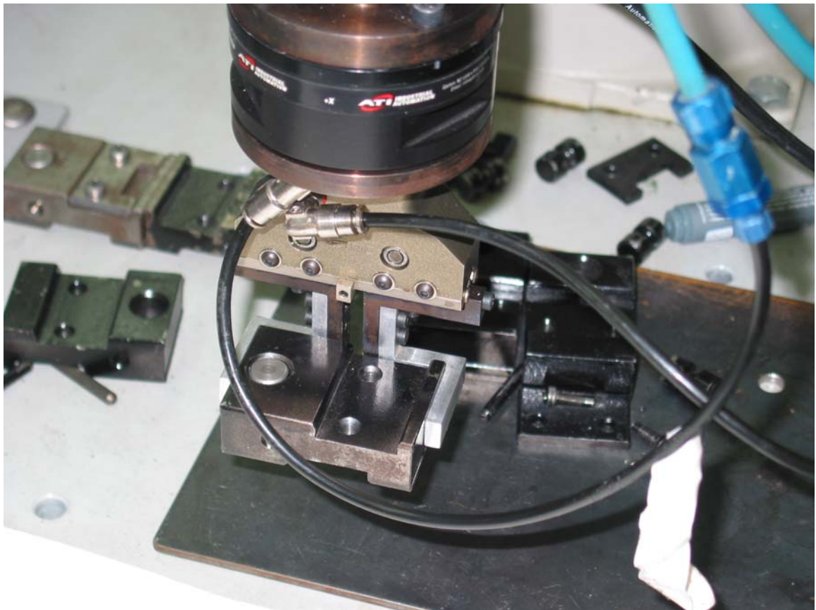
Slika 20. Robot sa sklopom u hvataljci
